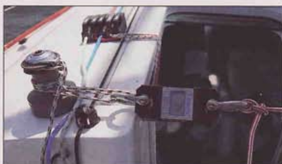
Les mesures. Un dynamomètre placé sur la bosse de réglage validait la tension appliquée.
